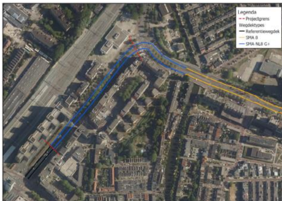
Figuur 4: Wegdektypes in de toekomstige situatie met voorgestelde maatregelen. Grenzen van fysiek te wijzigen wegdelen zijn weergegeven met rode stippellijnen.
